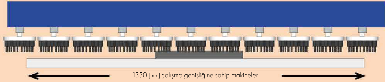
AĞIR CURUF GİDERME işlemi için sertleştirilmiş çelik pimli destek pedleri
