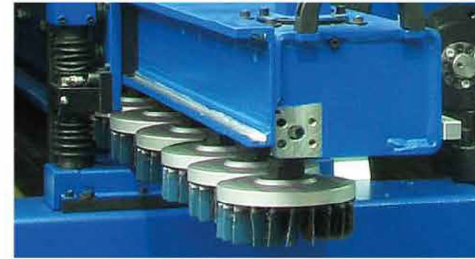
Aşındırıcı insertli XVS Ø 130 mm ile çapak alma ve kenar yuvarlama
