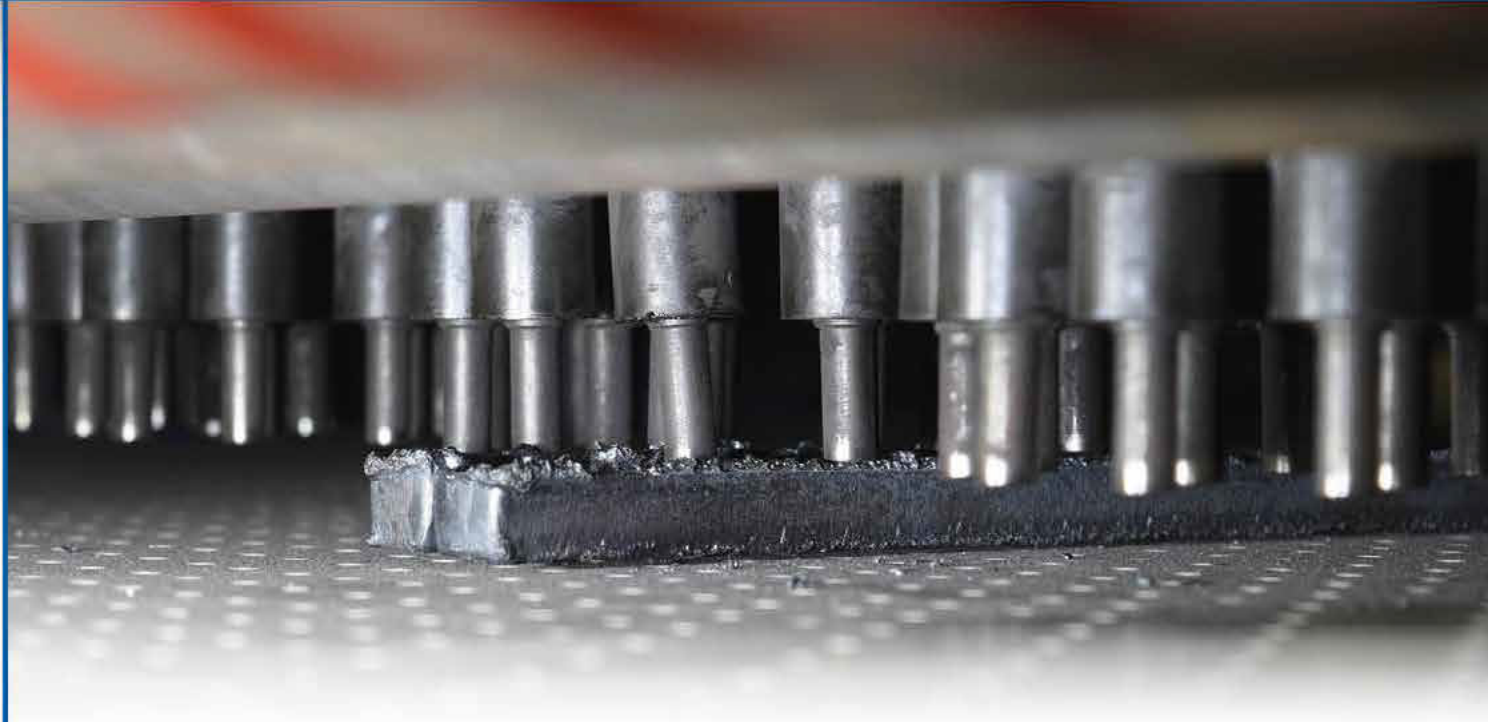
AĞIR CURUF GİDERME işlemi için sertleştirilmiş çelik pimli destek pedleri
